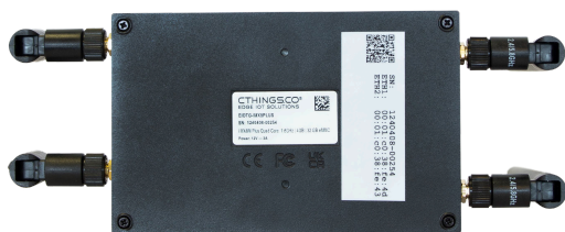
Edge IoT Gateway Antennas: 2x LTE + 1x Wi-Fi + 1x BT
