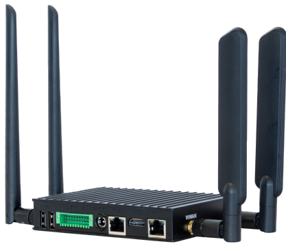
Edge IoT Gateway Antennas: 2x LTE + 1x Wi-Fi + 1x BT
